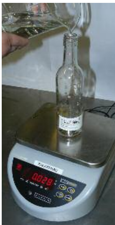
Figura 1 - Riempimento di una bottiglia per pesatura.
